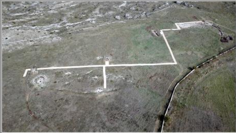
Massicciata di stabilizzato (breccia - ghiaia) realizzata sul Villaggio Neolitico
